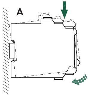
B. 用螺丝刀在安全继电器一端的卡扣处按箭头所示方向稍微撬起安全继电器，从而向外牵动卡扣，旋转安全继电器：
