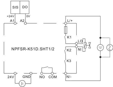
该示例图为SIS系统的DO信号作为安全继电器的输入信号，控制继电器输出回路的闭合和断开，当SIS系统输出高电平时，继电器输出回路闭合，当SIS系统输出低电平时，继电器输出回路断开。
